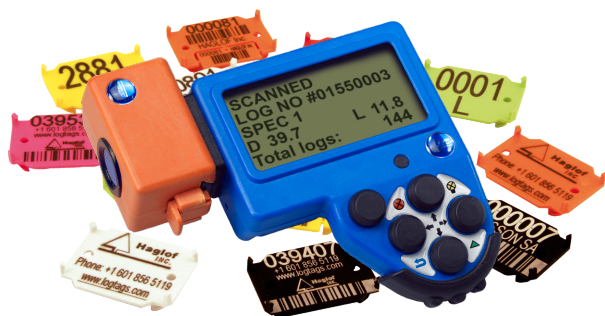
La imagen muestra el DP Scanner conectado al terminal de la DP II. Use el DP Scanner con la DP II y sus sistemas de etiquetado de troncos. Marque el árbol o el tronco con una etiqueta con código de barras impreso. Mida y registre los datos en la DP. Escanee el código de barras. Los datos se almacenan con el código y sus resultados de medición están vinculados al objeto correcto.
