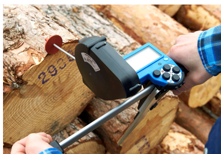
Use el tapón de protección en el gancho del extremo afilado para sacar el cable de medición recto del soporte de Digitech Tape.
